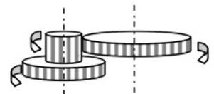
3.5. Die Abbildung zeigt, wie das Hinterrad eines Fahrrades durch eine Kette angetrieben wird. Dabei kommen drei Räder (1), (2) und (3) vor mit den Radien  $r_1 = 80$  cm,  $r_2 = 5$  cm,  $r_3 = 10$  cm.
