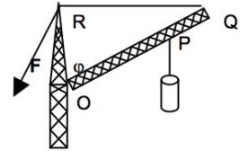
(1.34) Der Balken hat die Masse  $m = 80$  kg und ist  $l = 10$  m lang. Er bildet mit der Horizontalen den Winkel von  $\alpha = 50^\circ$ . Der Balken wird durch ein Seil gehalten, das durch die Kraft  $F$  gespannt ist.
