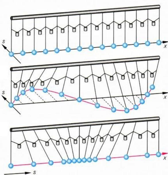
Im Bild sieht man eine Reihe von Fadenpendeln, die über kleine Gewichte miteinander gekoppelt (verbunden) sind. Je nachdem wie man das erste Pendel auslenkt, entstehen unterschiedliche Wellen, die sich im Medium "Pendelkette" ausbreiten.
