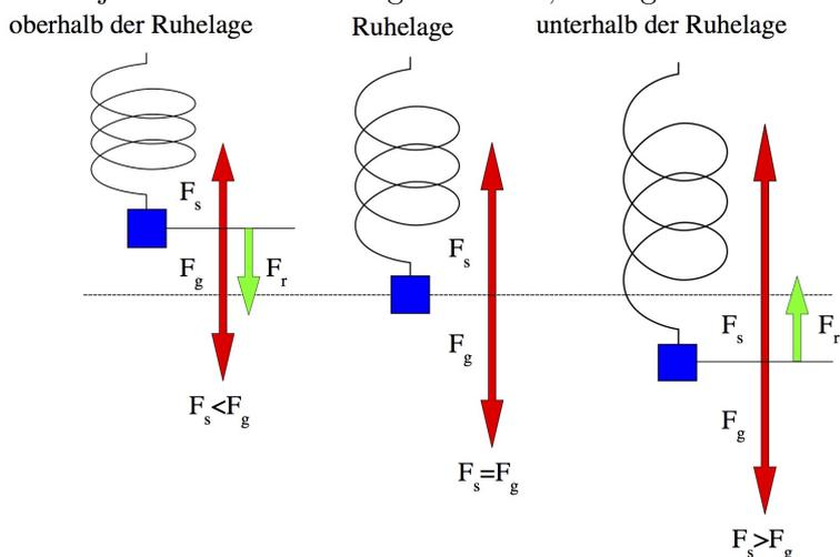
Die rücktreibende Kraft  $F_{\text{rück}}$  ist in diesem Fall immer die Differenz zwischen Federkraft  $F_{\text{feder}}$  und Gewichtskraft  $F_g$ . Sie zeigt immer zur Ruhelage zurück. Die Auslenkung wird mit  $y(t)$  bezeichnet. Man kann ansetzen
