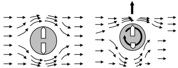
Im rechten Bild sieht man eine rotierende Kugel im Luftstrom. Wenn es Reibung zwischen Luft und Kugel gibt, so wird die Kugel oberhalb beschleunigt und unterhalb abgebremst. Der Wanddruck ist an der Oberseite noch negativer (stärker) als unten. Die Gesamtwirkung ist, dass die rotierende Kugel im Luftstrom nach oben steigt.
